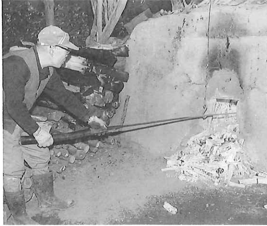
写55 「エンブリ」による掻き出し
